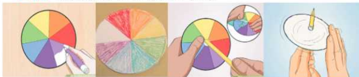
चित्र 15.21 (क) : कागज की डिस्क पर सात रंग भरें चित्र 15.21 (ख) : न्यूटन डिस्क चित्र 15.21 (ग) : पेंसिल की नोक पर फिट करें। चित्र 15.21 (घ) : डिस्क को तेज़ घुमाने पर यह सफेद नज़र आती है।
