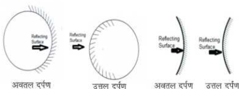
चित्र 15.8 (क) : काँच का खोखला गोला, जिसकी भीतरी तथा बाहरी परावर्तक सतह अवतल तथा उत्तल दर्पण बनाते हैं।
